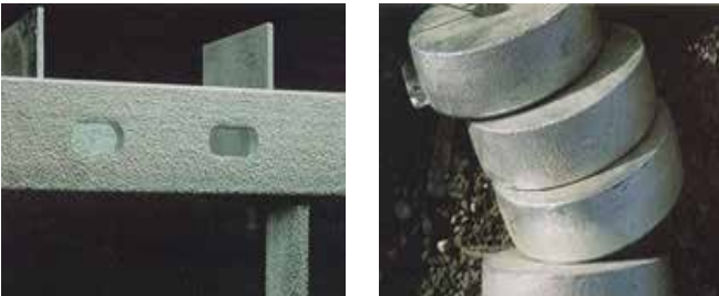
Şekil 6. Pürüzlü yüzey hatasına sahip kaplamaya ait bir yüzey görüntüsü
