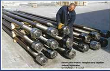
Alstom-Ekon Prokon 10 metre boyda 150 mm çapta(1,5 ton/ad) Konukoğlu Barajı Kapak Ankerajları
