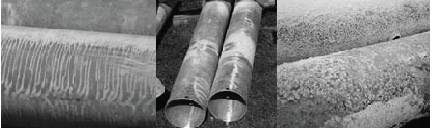
Şekil 12. Nemli ortamlarda depolama yüzünden oluşan lekeler örnekler
