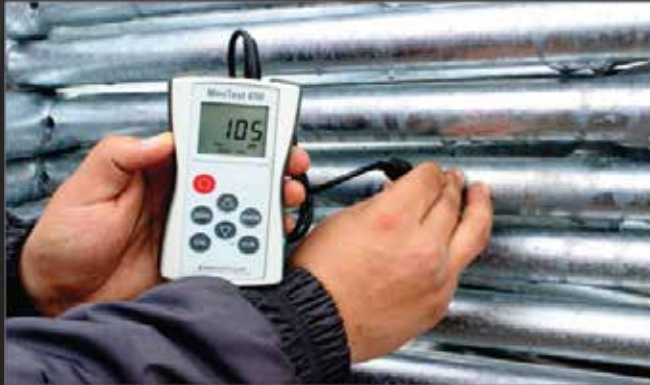
Şekil 2. Mikrometre ile kaplama kalınlığı ölçümü
