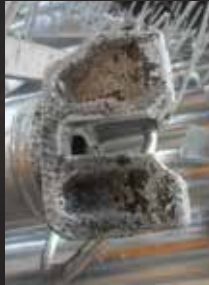
Şekil 7. Kumlatılmamış döküm uç
