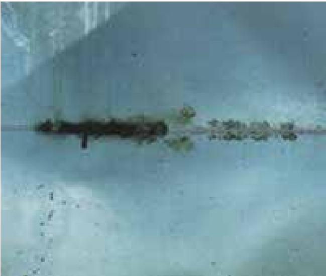
Şekil 10. Yüzeyde kalan çinko köpüğü kalıntısına örnek
